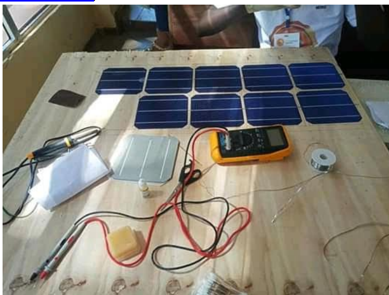
Module solaire en cours de montage.
