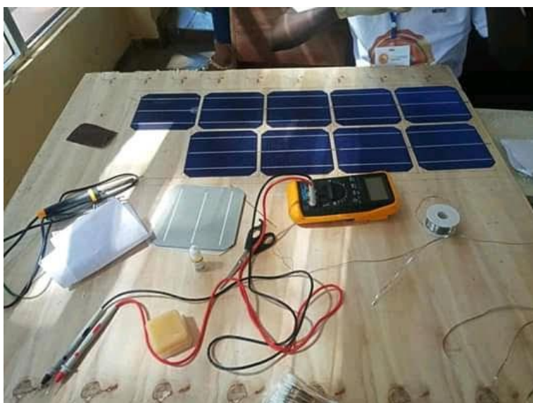
Module solaire en cours de montage.
