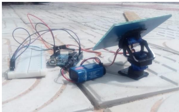
Figure 1 : Prototype d'héliostat élaboré
