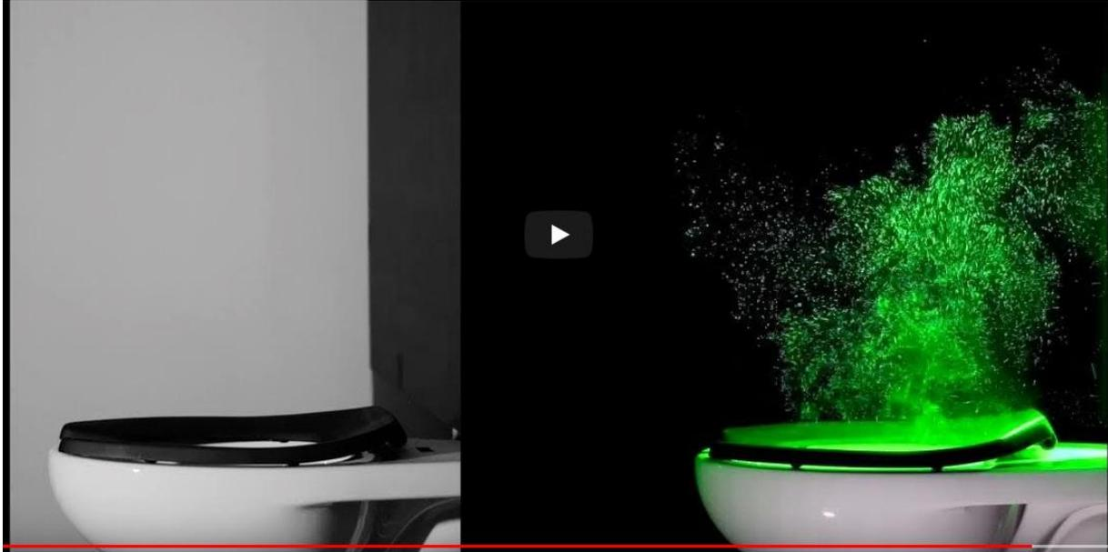
Nous profitons de cette nouvelle pour montrer la méthode de visualisation des aérosols qui sont le « moyen de transport » de nombreux pathogènes. Côté gauche, sans éclairage par laser on ne voit pas les aérosols mis en évidence côté droit par l'éclairage laser (532 nm).
